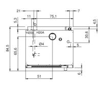
G: Gasanschluss E: Elektrobetrieb D: Wasserablauf
